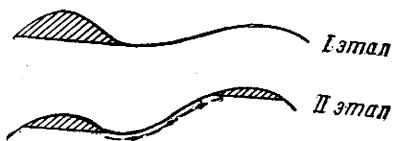
Рис. 1. Схема перетока нефти из существующей залежи при тектонических движениях.
